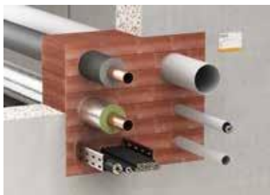
Joonis 1. PYROPLUG® Block tuletõkkeisolatsiooni vahtplokk massiivseinäs (vasakul) ja kergvaheseinas (paremal)
